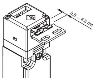
El actuador de este interruptor tiene mucho rango de movimiento en el cabezal. De este modo, el resguardo puede oscilar a lo largo de la dirección de inserción (4 mm) sin causar paros indeseados de la máquina. Este amplio rango de movimiento está disponible en todos los actuadores para garantizar la máxima fiabilidad del dispositivo.
