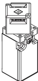
Para hacer más seguro y sencillo el ajuste del cabezal, estos interruptores disponen de un sistema especial de fijación del cabezal al cuerpo. Esto significa que el cabezal no se puede retirar del dispositivo ni siquiera durante el ajuste, por lo que no es necesario utilizar tornillos unidireccionales para fijar el cabezal una vez ajustado. Esta solución está disponible en las series FR, FX y FK.
