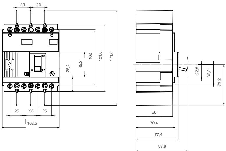
Notas: 1) Para dimensões de conexão com barras ver tabela "Conexão Direta de Barra ao Disjuntor".
