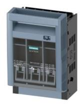
SENTRON, fusible-interruptor-seccionador 3NP1, 3 polos, NH000, 160 A, para montaje e instalación en placa de montaje, borne de caja, plano de cubierta 45 mm
