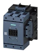
contactor de potencia, AC-3 115 A, 55 kW/400 V AC (50-60 Hz)/mando por corriente continua 23-26 V AC/DC contactos auxiliares 2 NA + 2 NC tripolar, tamaño S6 con bornes tipo marco accionamiento: convencional borne de tornillo
