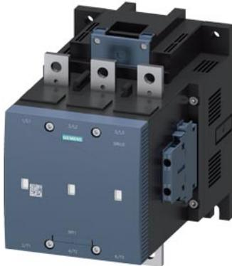
contactor de vacío, AC-3 500 A, 250 kW/400 V AC (50-60 Hz)/mando por corriente continua 220-240 V AC/DC contactos auxiliares 2 NA + 2 NC tripolar, tamaño S12 conexiones de barras accionamiento: convencional
