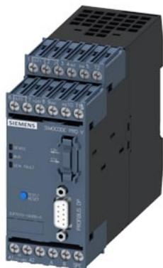
Unidad base SIMOCODE pro V PB, Interfaz PROFIBUS DP 12 Mbits/s, RS-485, 4E/3S libremente parametrizables, US: 110...240 V AC/DC, entrada para termistor salidas de relé monoestables, ampliable mediante módulos de ampliación
