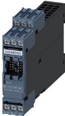
Módulo digital, 4 entradas y 2 salidas de relé, tensión de entrada 110-240 V AC/DC salidas de relé monoestables, máx. 2 módulos digitales, para unidad base SIMOCODE pro V,
