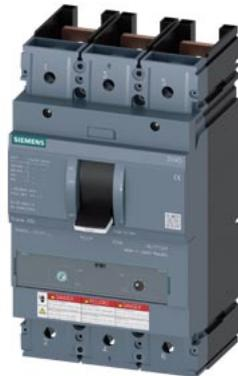
Interruptor automático 3VA5 UL tamaño 600 Clase de poder de corte H 65 kA @ 480 V 3 polos, protección de distribuciones TM240, ATAM,  $I_n=500$  A protección de sobrecarga  $I_r=400$  A...500 A protección de cortocircuito  $I_i=5...10 \times I_n$  Sin conexión
