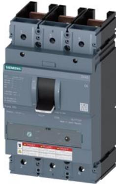
Interruptor automático 3VA5 UL tamaño 600 Clase de poder de corte H 65 kA @ 480 V 3 polos, protección de distribuciones TM240, ATAM,  $I_n=600$  A protección de sobrecarga  $I_r=480$  A...600 A protección de cortocircuito  $I_i=4...8 \times I_n$  sin conexión
