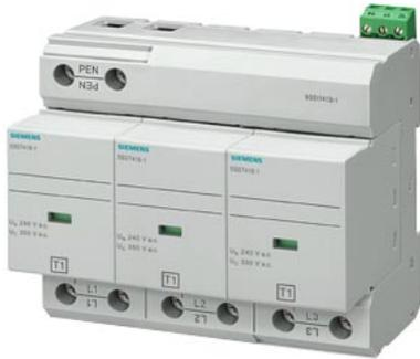
Pararrayos tipo 1 Clase de exigencia B, UC 350V Módulos de protección enchufables 3 polos, circuito 3+0 para sistemas CNC con visualizador remoto
