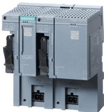
acoplador PN/MF SIMATIC acoplador bus de campo múltiple, PN IO, EtherNet/IP, para el intercambio determinista de datos entre máx. 1 controlador por cada lado, inyección de corriente redundante, conexión Ethernet a través de BusAdapter SIMATIC (BA), suministro sin BusAdapter
