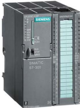
SIMATIC S7-300, CPU 313C-2 DP CPU compacta con MPI, 16 DI/16 DO, 3 contadores rápidos (30 kHz), interfaz DP integrada, alimentación de DC 24V integrada, memoria de trabajo de 128 Kbytes, conector frontal (1 x 40 polos) y Se necesita Micro Memory Card
