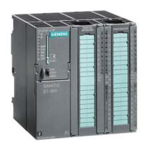
SIMATIC S7-300, CPU 314C-2 DP CPU compacta con MPI, 24 DI/16 DO, 4 AI, 2 AO, 1 Pt100, 4 contadores rápidos (60 kHz), interfaz DP integrada, alimentación de DC 24V integrada, memoria de trabajo de 192 Kbytes, conector frontal (2x 40 polos) y Se necesita Micro Memory Card
