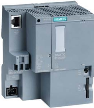
SIMATIC DP, CPU 1510SP-1 PN para ET 200SP, Módulo central con Memoria de trabajo de 100 KB para programa y 750 KB para datos, 1.<sup>a</sup> interfaz: PROFINET IRT con switch de 3 puertos, 72 NS rendimiento bits, SIMATIC Memory Card necesaria, adaptador de bus necesario para puertos 1 y 2
