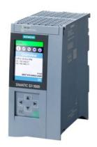
SIMATIC S7-1500, CPU 1515-2 PN, módulo central con memoria de trabajo de 500 kB para programas y 3 Mbytes para datos, 1.ª interfaz: PROFINET IRT con switch de 2 puertos, 2.ª interfaz: PROFINET RT, 30 ns rendimiento bits, SIMATIC Memory Card necesaria
