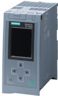
SIMATIC S7-1500R, CPU 1515R-2 PN módulo central con memoria de trabajo de 500 kB para programas y 3 Mbytes para datos, 1.ª interfaz: PROFINET RT con switch de 2 puertos, 2.ª interfaz: PROFINET, se necesita SIMATIC Memory Card
