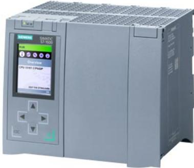
SIMATIC S7-1500T, CPU 1516T-3 PN/DP, módulo central con memoria de trabajo de 1,5 MB para programa y 5 MB para datos, 1.<sup>a</sup> interfaz: PROFINET IRT con switch de 2 puertos, 2.<sup>a</sup> interfaz, Ethernet, 3.<sup>a</sup> interfaz, PROFIBUS, 10 NS rendimiento bits, SIMATIC Memory Card necesaria
