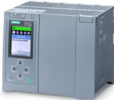
SIMATIC S7-1500, CPU 1518-4 PN/DP, módulo central con memoria de trabajo de 6 MB para programa y 60 MB para datos, 1.ª interfaz: PROFINET IRT con switch de 2 puertos, 2.ª interfaz: PROFINET RT, 3.ª interfaz: Ethernet, 4.ª interfaz: PROFIBUS, 1 NS rendimiento bits, SIMATIC Memory Card necesaria
