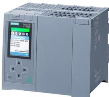
SIMATIC S7-1500, CPU Bundle compuesto por: CPU 1518-4 PN/DP MFP (6ES7518-4AX00-1AB0), incluye C/C++ Runtime y licencia OPC UA Runtime, memoria de trabajo de 6 Mbytes para programa y 60 Mbytes para datos, 1.<sup>a</sup> interfaz: PROFINET IRT con switch de 2 puertos, 2.<sup>a</sup> interfaz: PROFINET RT, 3.<sup>a</sup> interfaz: PROFINET servicios básicos, 4.<sup>a</sup> interfaz: PROFIBUS, 1 NS rendimiento bits, SIMATIC Memory Card (mín. 2 GB) necesaria
