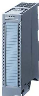
SIMATIC S7-1500, módulo de entradas digitales DI 16XDC 24 V BA, fuente; 16 canales en grupos de 16; retardo a la entrada 3,2 ms; tipo entrada 3 (IEC 61131); el conector frontal (bornes de tornillo o inserción rápida) debe pedirse por separado
