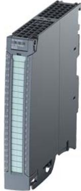
SIMATIC S7-1500, módulo de salidas digitales DQ16xDC 24V/0,5A HF; 16 canales en grupos de 8; 4 A por grupo; diagnóstico de canal individual; valor sustitutivo: contador de maniobras para actuadores conectados. el módulo admite la desconexión de seguridad de grupos de carga hasta SIL 2 según EN IEC 62061:2021 y Cat. 3/PL d según EN ISO 13849-1:2015 conector frontal (bornes de tornillo o de inserción rápida) pedir por separado
