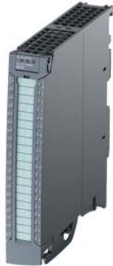
SIMATIC S7-1500, módulo de salidas digitales DQ 32xDC 24V/0,5A HF; 32 canales en grupos de 8; 4 A por grupo; diagnóstico de canal individual; valor sustitutivo, contador de maniobras para actuadores conectados. el módulo admite la desconexión de seguridad de grupos de carga hasta SIL 2 según EN IEC 62061:2021 y Cat. 3/PL d según EN ISO 13849-1:2015 conector frontal (bornes de tornillo o de inserción rápida) pedir por separado
