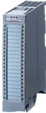
SIMATIC S7-1500, módulo de salidas digitales DQ 8xAC 230V/5A ST; relé; 8 canales en grupos de 1; 5 A por grupo; diagnóstico; valor sustitutivo: contador de maniobras para relé integrado, el módulo admite la desconexión de seguridad de grupos de carga hasta SIL 1 según EN IEC 62061:2021 y Cat. 2/PL c según EN ISO 13849-1:2015 conector frontal (bornes de tornillo o de inserción rápida) pedir por separado
