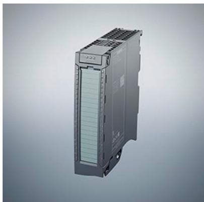
SIMATIC S7-1500, módulo de salidas digitales DQ 16x 230V AC/2A ST; relé 16 canales en grupos de 2; 4 A por grupo; contador de maniobras para relé integrado, diagnóstico; valor sustitutivo: el módulo admite la desconexión de seguridad de grupos de carga hasta SIL 1 según EN IEC 62061:2021 y Cat. 2/PL c según EN ISO 13849-1:2015 conector frontal (bornes de tornillo o de inserción rápida) pedir por separado
