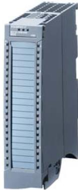
SIMATIC S7-1500, módulo de entradas analógicas AI 8xU/I/RTD/TC ST, Resolución de 16 bits, precisión 0,3 %, 8 canales en grupos de 8, 4 canales para medición de RTD, tensión en modo común 10V; diagnóstico; alarmas de proceso; El suministro incluye elemento de alimentación, abrazadera de pantalla y clip de pantalla: conector frontal (bornes de tornillo o de inserción rápida) pedir por separado
