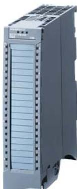
SIMATIC S7-1500, módulo de entradas analógicas AI 8 x U/I HS, Resolución de 16 bits, precisión 0,3% 8 canales en grupos de 8, tensión en modo común 10V; diagnóstico; alarmas de proceso 8 canales en 0,0625 ms oversampling; El suministro incluye elemento de alimentación, abrazadera de pantalla y clip de pantalla: conector frontal (bornes de tornillo o de inserción rápida) pedir por separado
