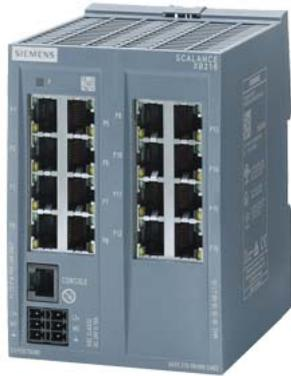
SCALANCE XB216 manageable Layer 2 IE Switch, 16x puertos RJ45 10/100 Mbits/s, 1 puerto de consola, LED de diagnóstico alimentación redundante con certificación IEC 62443-4-2; rango de temperatura de 0 °C a +60 °C; montaje sobre perfil DIN, PROFINET IO Device certificado EtherNet/IP, PROFINET predeterminado
