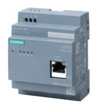
LOGO! CSM12/24 Compact Switch Module para conectar un LOGO! (. ..0BA7/...0BA8) y hasta 3 dispositivos más a Ind. Ethernet a 10/100 Mbits/s unmanaged Switch, 4 puertos RJ45, 1 puerto frontal para diagnóstico, alimentación 12/24 V DC diagnóstico LED, diseño LOGO!
