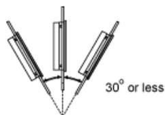
Si coloca este producto con una inclinación superior a 30°, la temperatura ambiente no debe superar los 40 °C (104 °F). Puede que sea necesario utilizar un sistema de enfriamiento por aire forzado (ventilador, aire acondicionado) para garantizar que la temperatura ambiente de funcionamiento sea de 40 °C o menos (104 °F o menos).
