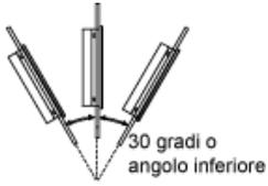
Si coloca el panel con una inclinación superior a 30°, la temperatura ambiente no debe superar los 40 °C (104 °F). Puede que sea necesario utilizar un sistema de enfriamiento por aire forzado (ventilador, aire acondicionado) para garantizar que la temperatura ambiente de funcionamiento sea de 40 °C o menos (104 °F o menos).
